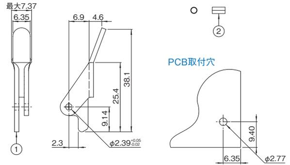
※本製品は上図と同じものが1個、上図と対称形のもが1個の合計2個の構成になります。
