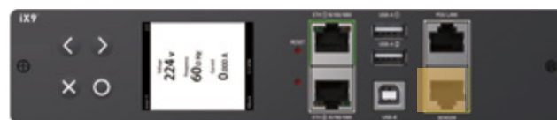
Xerus対応電源管理機器のコントローラー上のRJ45センサーポート (コントローラーの設計は、ブランド、モデル、バージョンによって異なります)
